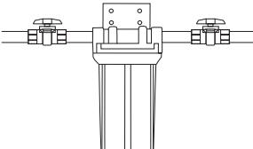
Рис. 2 Montaż pojedynczego filtra na rurze doprowadzającej gorącą wodę
